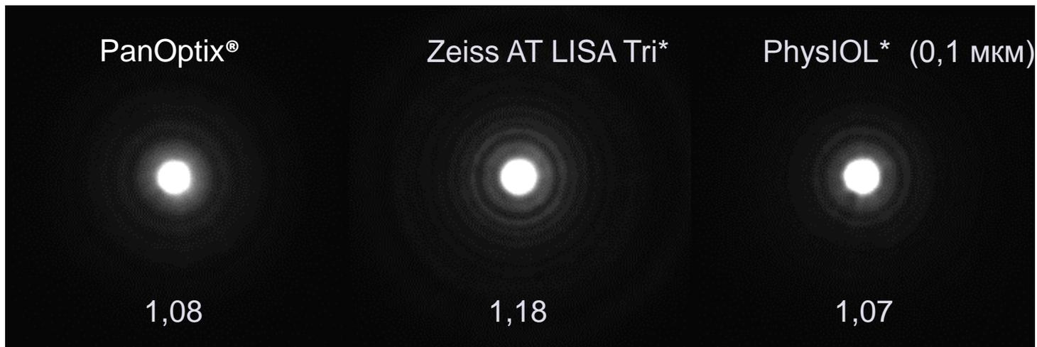
Симуляция изображений налбного осветителя приблизительно с 250 м через точечное отверстие 50 мкм с использованием модели глаза со сферической аберрацией (зрачок 5 мм).
